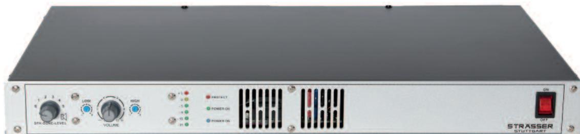
Der akustische Verstärker verfügen über eine Endstufe der Klasse D, symmetrische Eingänge 0dB und +6 dB, 0dB Ausgang, Gain, Höhen und Tiefen Einstellung. Diese Geräte haben eine Combo-Buchse, Kabel mit XLR oder Jack Anschluss.
